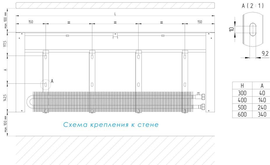
Схема крепления к стене
