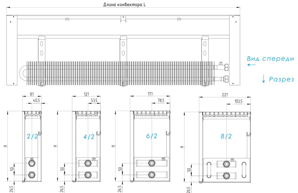
Настенный конвектор SPL Basic WM высота H мм ,ширина 70-220 мм
