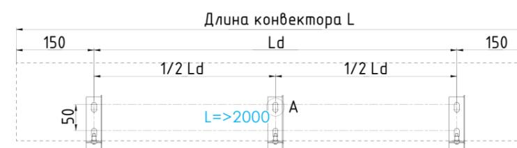
Схема крепления к стене
