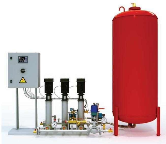
Автоматические установки поддержания давления и заполнения SPL® поддерживают заданное рабочее давление в системе, осуществляют компенсацию температурного расширения теплоносителя, его деаэрацию, пополнение потерь теплоносителя и заполнение системы в соответствии с действующими нормативно-техническими документами СП и СНиП, связанными с проектированием тепловых пунктов.
