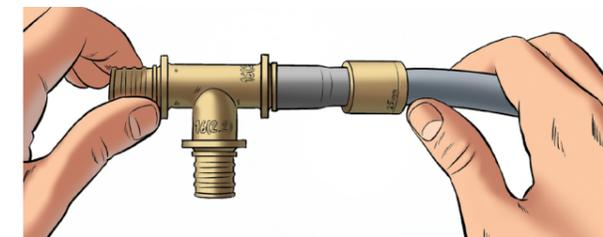
**5.** Надвинуть гильзу на фитинг до упора с помощью ручного или гидравлического пресса. В процессе напрессовки инструмент держать под прямым углом, исключая перекосы фитинга и гильзы в губках тисков и относительно друг друга. В случае использования коротких гильз, см. обратную сторону инструкции.
