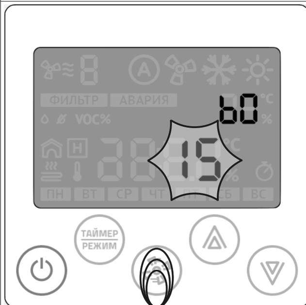
Кнопка «вентилятор» переключит режим выбора параметра на режим ввода значения параметра. Кнопка «вниз» или «вверх» будет менять значение выбранного параметра.
